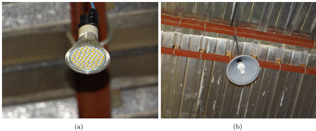
FIGURE 1: Les ampoules différentes qui étaient utilisé pendant le test. À gauche on peut voir un LED (3.5 W), à droite un CFL (11W) avec un abajou.
