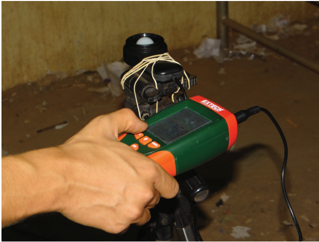
Abbildung 3: Luxmeter Extech HD400 mit verwendetem Stativ als Halterung der Fotodiode.
